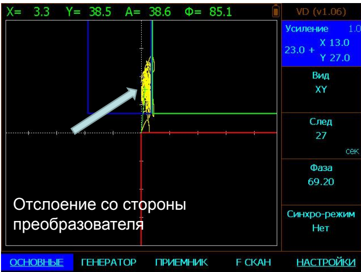
Сотовая конструкция самолета АН-24. Совмещенный импедансный преобразователь
