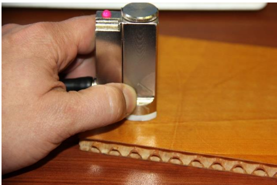
Сотовая конструкция самолета АН-24. Совмещенный импедансный преобразователь
